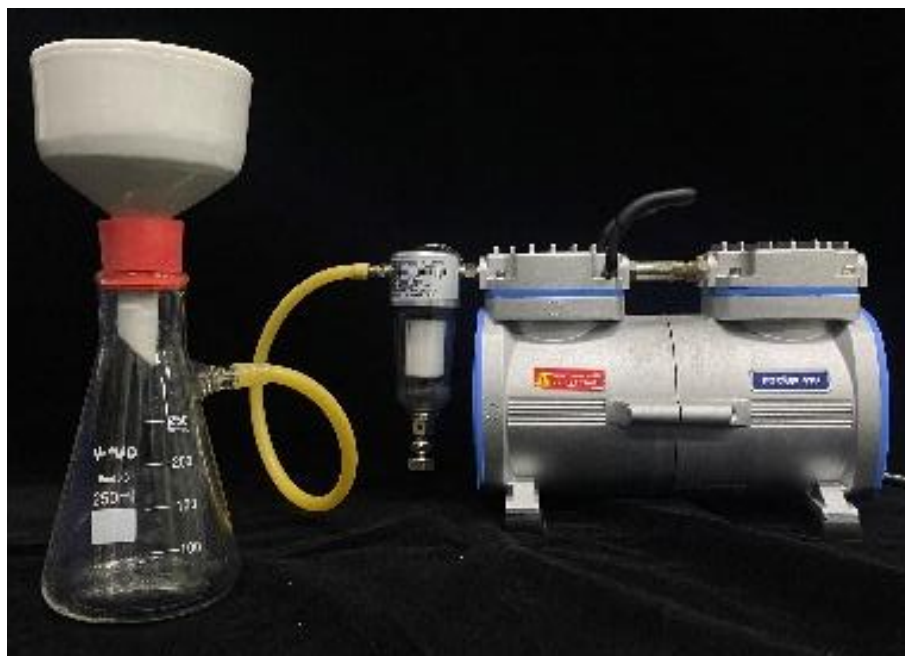
圖五、吸濾裝置（作者自行拍攝）
