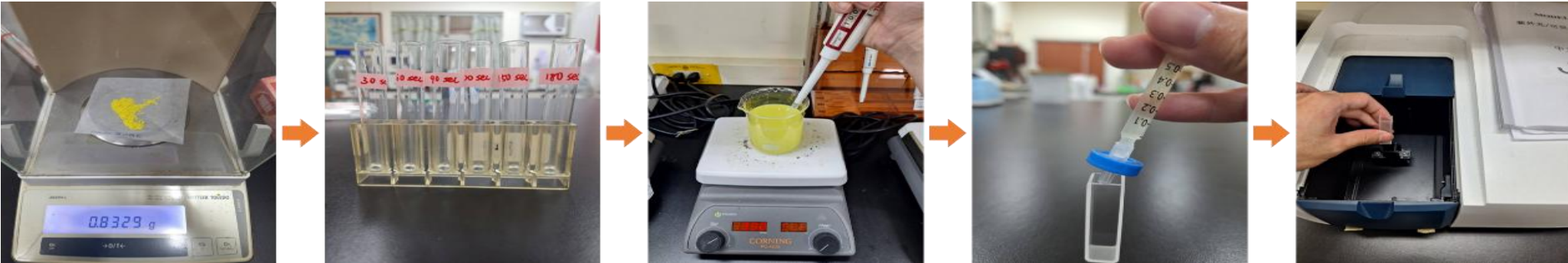
圖13 槲皮素發泡顆粒之有效成分溶出速率測定步驟 (作者親自拍攝)
