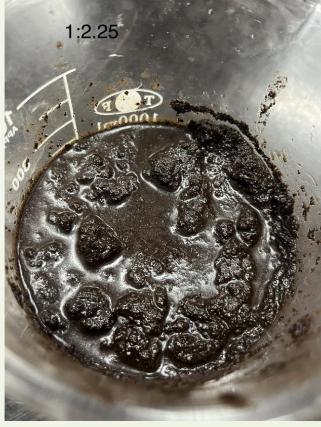
圖3d 粉水比1:2.25的出水狀況
