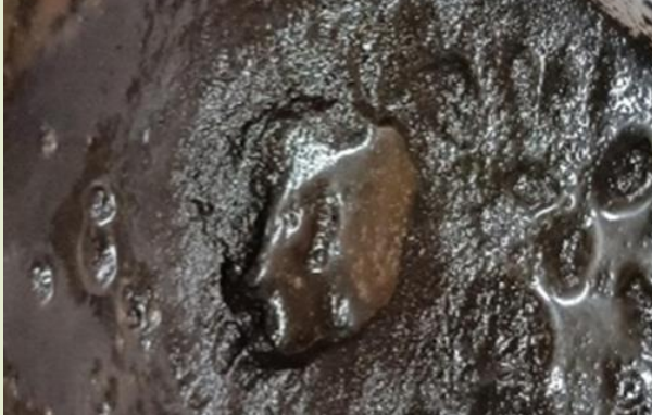
圖 5c 咖啡細粒渣出水情況圖
