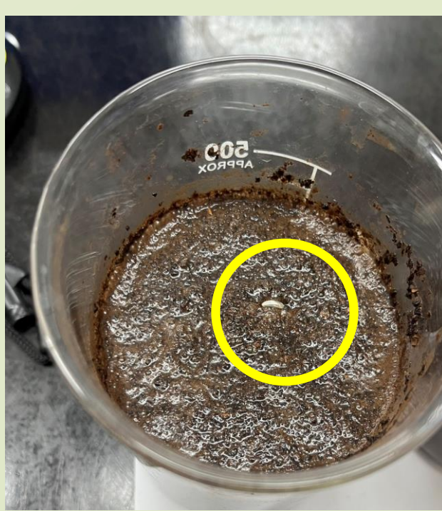
圖6e 粉水比1:3.0砝碼測試
