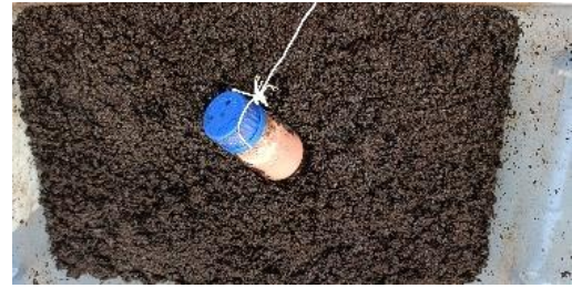
圖 血清瓶掉落在咖啡渣模型上(1:2.25)
