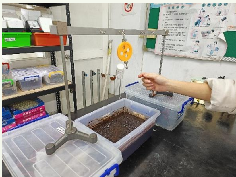
圖 4a.以鐵架測試式樣瓶 掉落及沉入狀況
