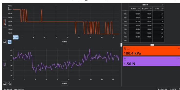
圖 42. 小便模擬器內部 Vernier 之氣壓值與水流力度變化量
