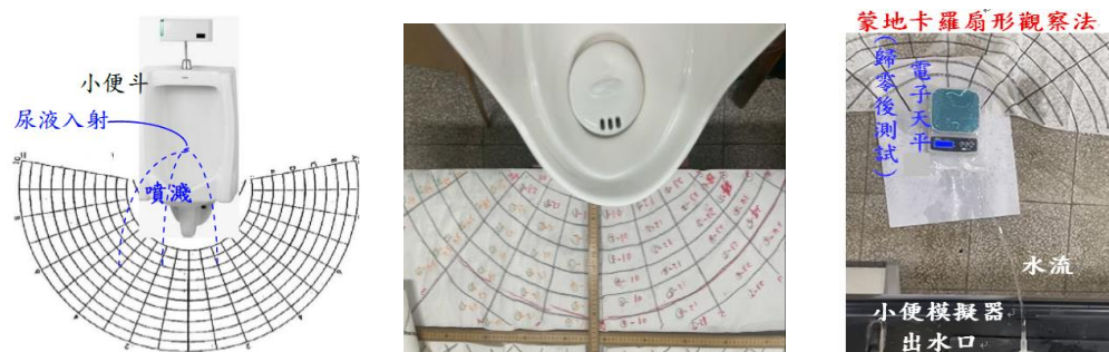
圖 45. 蒙地卡羅扇形觀察法 圖 46. 扇形格線與區域編號 圖 47. 液滴衝擊力初探
