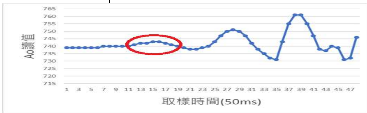
P1-17 水波電阻測量儀 A0 讀值隨時間變化曲線圖
