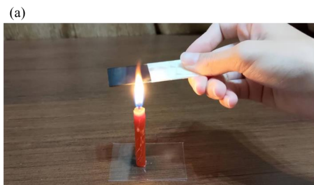
圖 5、碳黑載玻片。(a)以蠟燭燻黑載玻片，(b)碳黑載玻片(左側)/原始載玻片(右側)
