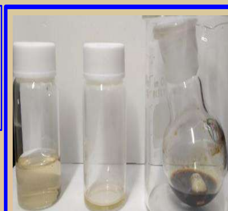
相片二十：芒草醋液分餾結果 圖中：室溫~75°C，佔 4.82 % 圖左：75°C~98°C，佔 40.47 % 圖右：98°C以上，佔 54.71 %
