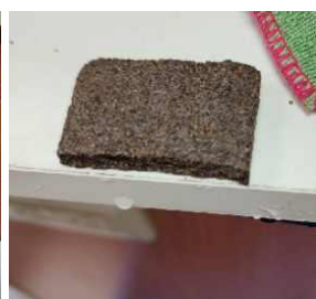
咖啡渣板材的斷裂面
