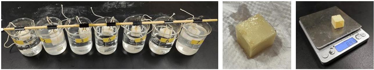
皂塊在不同濃度氫氧化鈉溶液浸泡情形
