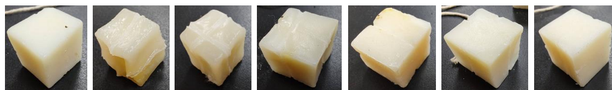
圖 4-4-1 一至七杯以氫氧化鈉溶液浸泡、烘乾後的皂塊
