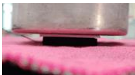
鍋子壓在導熱膠、板材上
