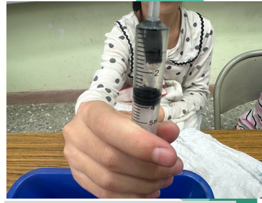
圖15、利用排水法測量體積。
