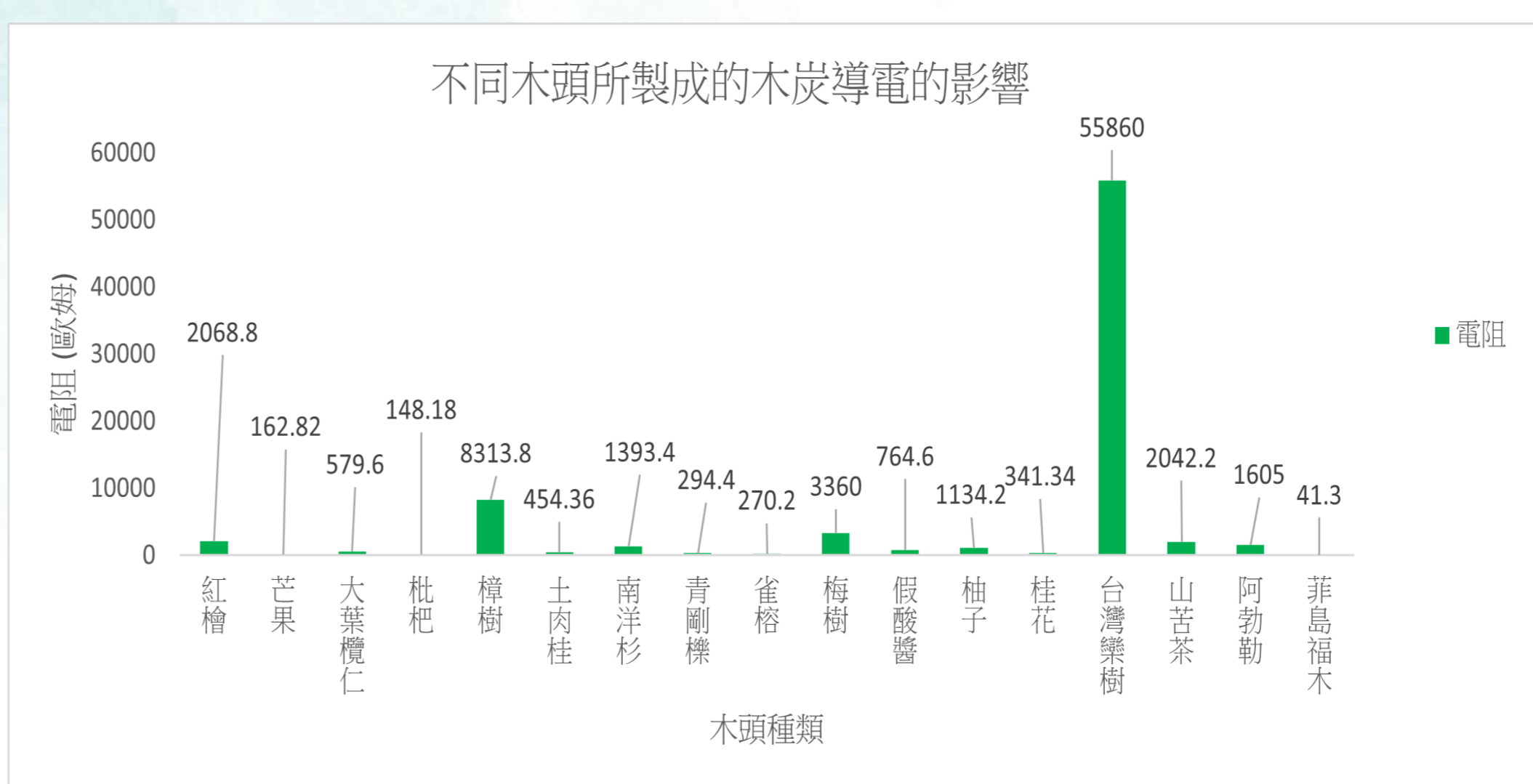
圖41、不同不同木頭所製成的木炭導電的影響。(自行繪製)
