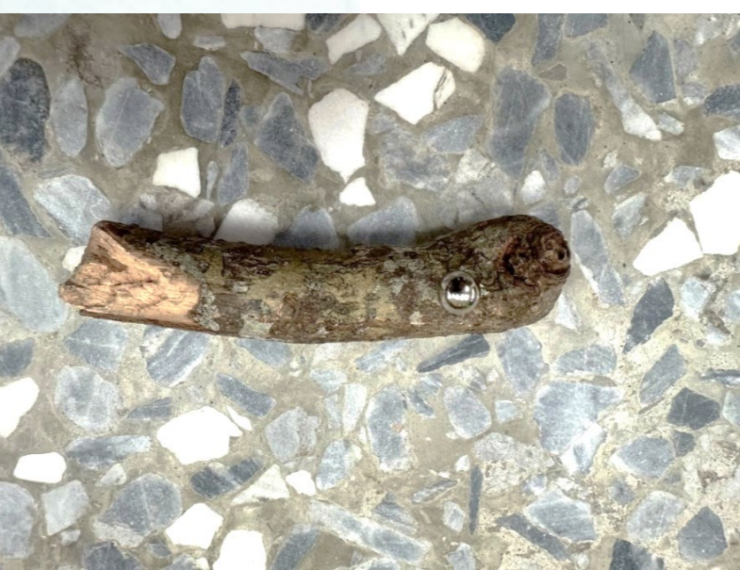
圖10、放置10mm小鋼球到木頭上。
