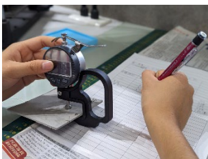
圖 6：使用厚度計測量水泥板的厚度。
