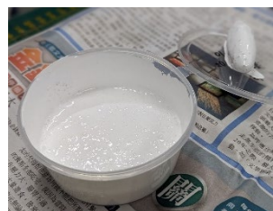
圖 16：不同比例二氧化鈦混入透明漆中。
