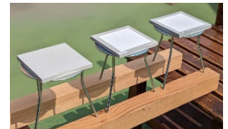
圖 36：日曬水泥板裝
