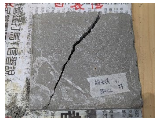
圖 7：一般水泥製作的水泥板容易碎裂。
