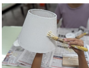
圖 43：將隔熱塗料塗在燈罩外側和內側。
