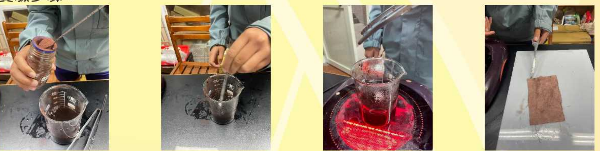
圖5-6-17：取200ml熱水加入色粉 圖5-6-18：攪拌均勻 圖5-6-19：火爐上加熱放入棉布 圖5-6-20：取出觀察顏色
