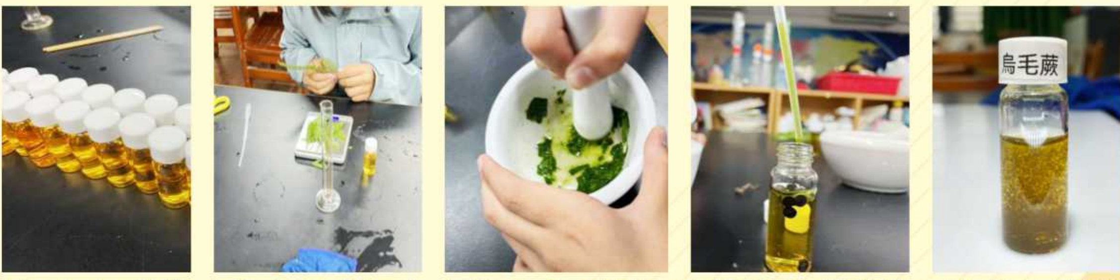
圖5-2-1：計數瓶中倒入5%氯化鐵溶液10ml 圖5-2-2：秤一公克蕨類葉片 圖5-2-3：加入10ml清水以研鉢研磨 圖5-2-4：滴管吸取植物汁液滴入氯化鐵溶液中 圖5-2-5：觀察變色情形
