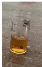
圖 6: 滴加 3 號測試劑 5 滴，搖動 30 秒
