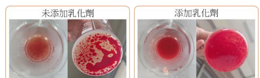
圖十七、含色素水的基底膏添加乳化劑隔水加熱攪拌的差異 (照片來源：指導老師拍攝)
