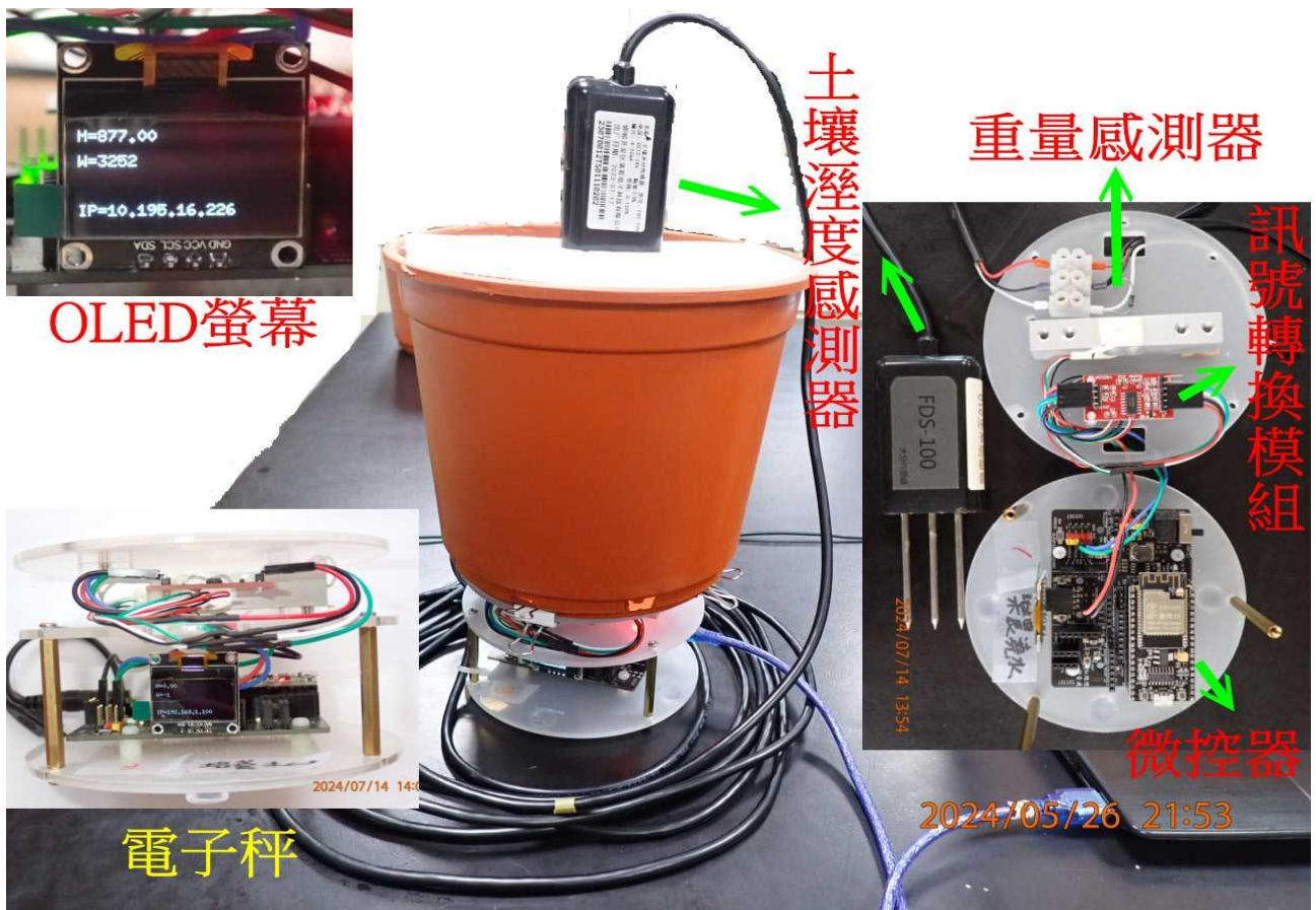
圖2-5 自製雲端土壤重量及溼度感測裝置
