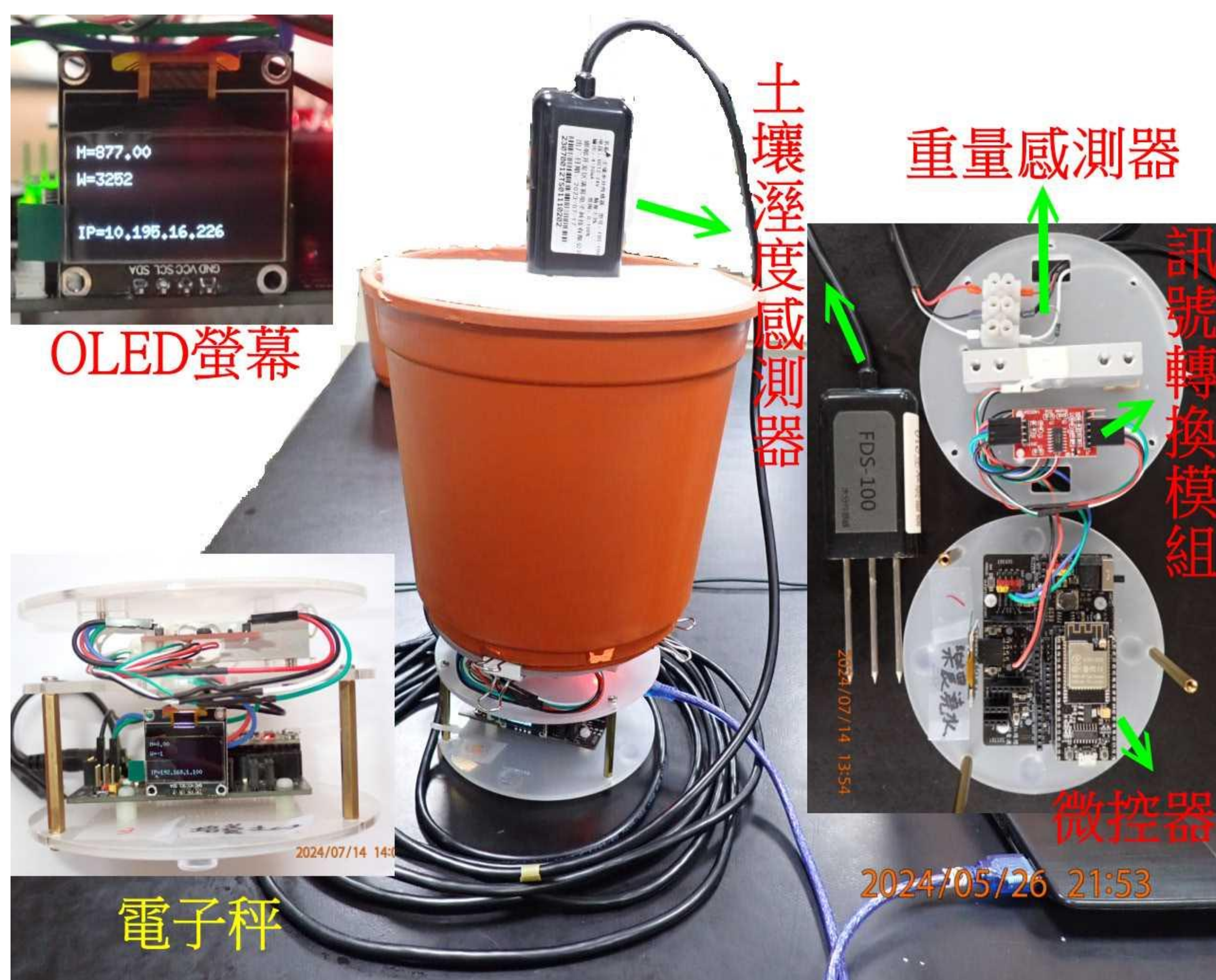
自製雲端土壤重量及溼度感測裝置
