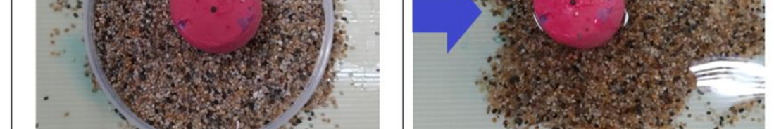
圖61、圓形模型放置已佈滿細沙的塑膠圓環中(來源:本研究自行拍攝)。
