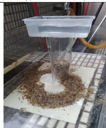
圖 84、長管雨水沖裝置在圓形模型周圍，泥沙沖刷效果明顯(來源:本研究自行拍攝)
