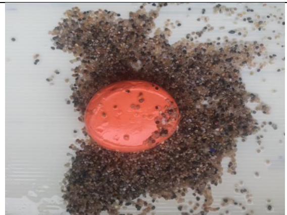
圖 64、橢圓形模型周圍在水流沖刷後泥沙堆積率為 70%(來源:本研究自行拍攝)
