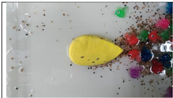
圖 78、水滴流線型的模型周圍，矽膠小魚堆積的樣態(來源:本研究自行拍攝)
