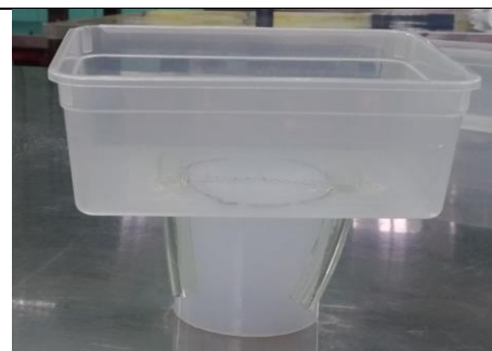
圖 82、雨水沖刷盒側面圖(來源:本研究自行拍攝)
