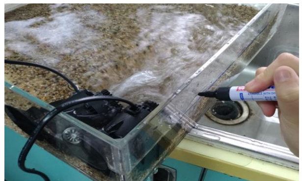
圖27、斷面做記號，擷取波高資料(來源:本研究自行拍攝)
