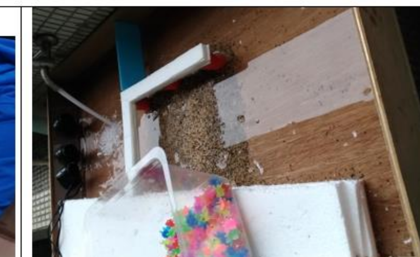
圖15、用木板自製長100公分、寬60公分、高10公分的河岸碼頭河道模型(來源:本研究自行拍攝)
