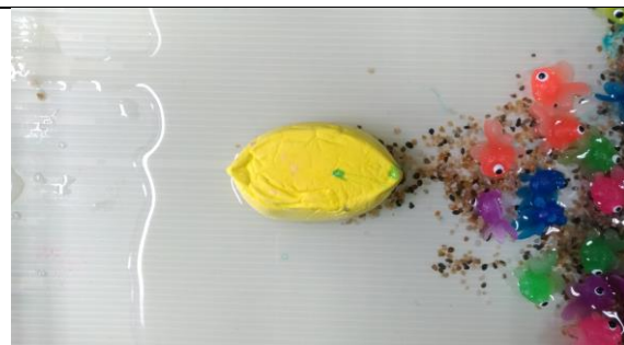
圖 79、雙尖流線型的模型周圍，矽膠小魚堆積的樣態(來源:本研究自行拍攝)
