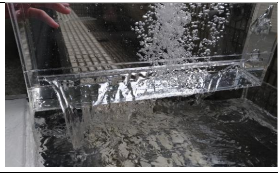
圖 21、壓克力製的水箱，出水口製造平穩的水流(來源:本研究自行拍攝)
