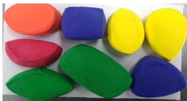
圖29、製作碼頭基樁不同幾何形狀的模型(來源:本研究自行拍攝)
