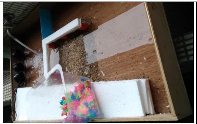
圖 15、用木板自製長 100 公分、寬 60 公分、高 10 公分的河岸碼頭河道模型(來源:本研究自行拍攝)
