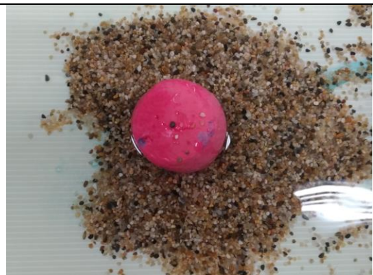
圖 62、圓形模型周圍在水流沖刷後泥沙堆積率為 64%(來源:本研究自行拍攝)
