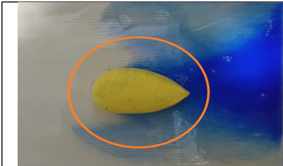
圖 55、水滴流線型模型經水流侵蝕後的藍色膠水痕跡(來源:本研究自行拍攝)
