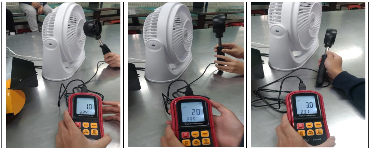
圖31、風速儀測風扇低風速每秒1公尺、中風速每秒2公尺、高風速每秒3公尺(來源:本研究自行拍攝)
