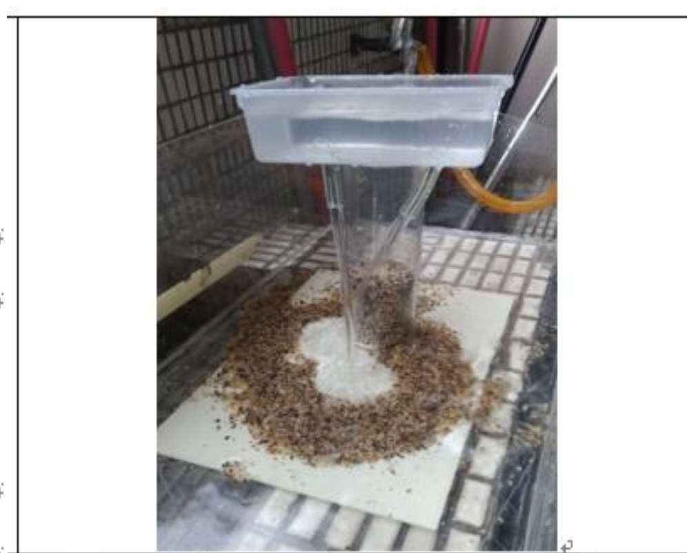
圖84、長管雨水沖裝置在圓形模型周圍，泥沙沖刷效果明顯(來源:本研究自行拍攝)。
