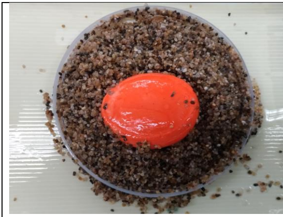
圖 63、橢圓形模型放置在鋪滿細沙的塑膠圓環中(來源:本研究自行拍攝)
