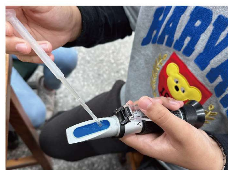
使用手持式折光儀(糖度計)測量茄汁糖度
