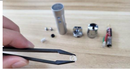
圖 11 雷射筆的零件
