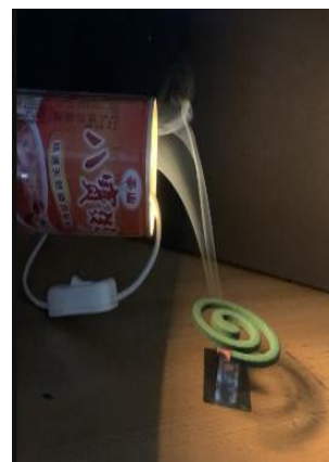
圖 19 煙被金爐口氣流吸入 (照片由第一指導老師拍攝)
