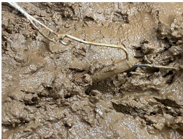
圖 11 魚鈎勾進管與線的交接處
