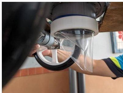
距離地面 1.0 cm實驗組被強大吸力壓扁(自攝)
