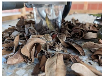
距離地面 1.5 cm實驗組大堆落葉卡在吸葉口周遭(自攝)
