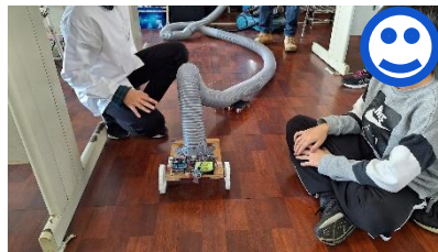
吸葉管底部加裝移動輪，電機輪胎仍在原地空轉(自攝)
