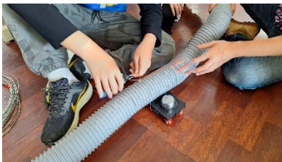
在吸葉管底部加裝移動輪，降低地上的摩擦力(自攝)
