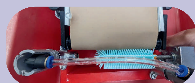
出水口水管在刮除器上方
