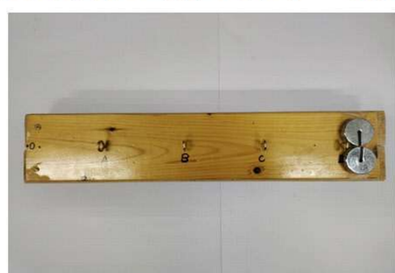
重壓板前端加砝碼模擬加重
