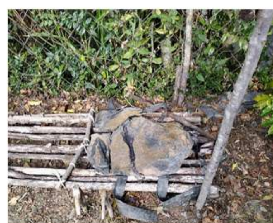
重壓板上綁石頭石塊容易碎裂
