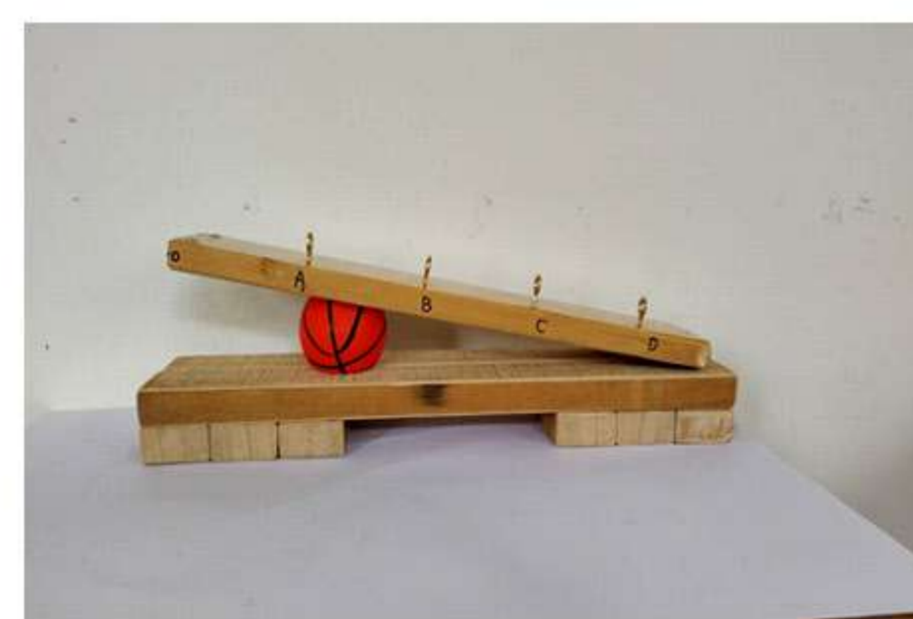
模擬獵物在重壓板較低處受撞擊
