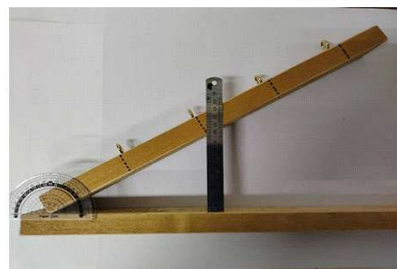
重壓板與地面成30度安置並量對應點高度
