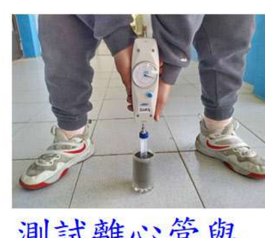
測試離心管與沙子的摩擦力
