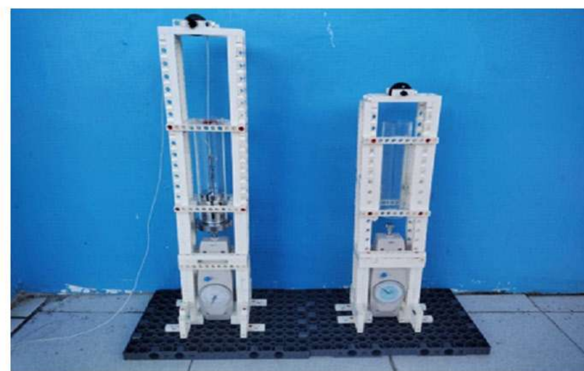
推力秤測試衝擊力模具
