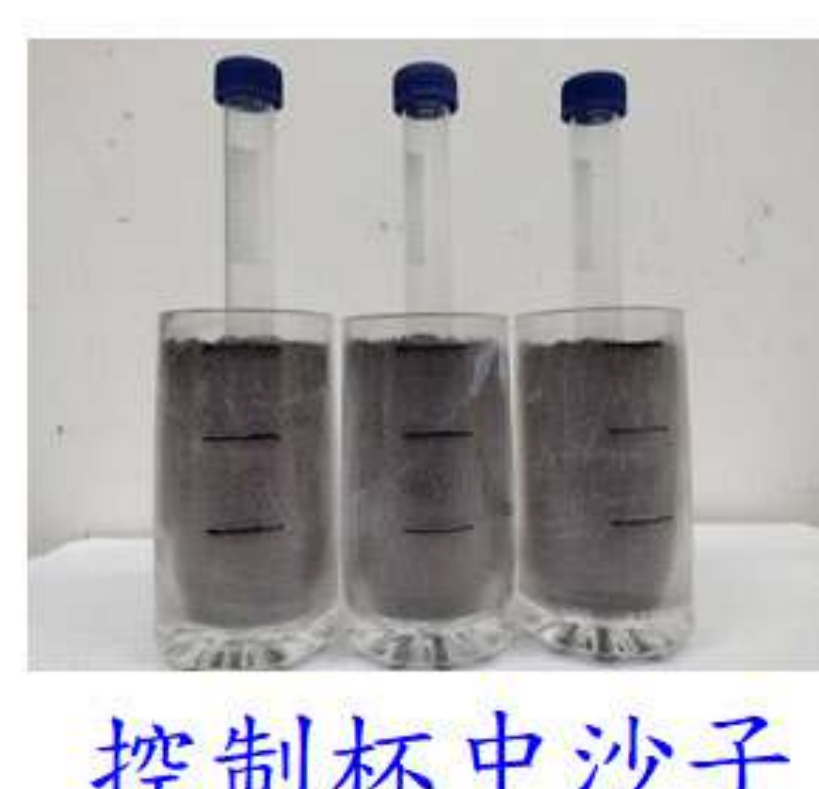
控制杯中沙子緊實度
