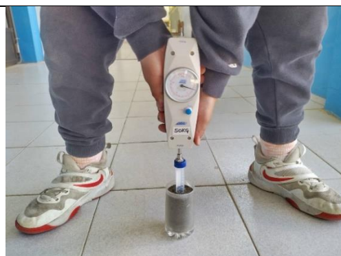
測試離心管與沙子的摩擦力
