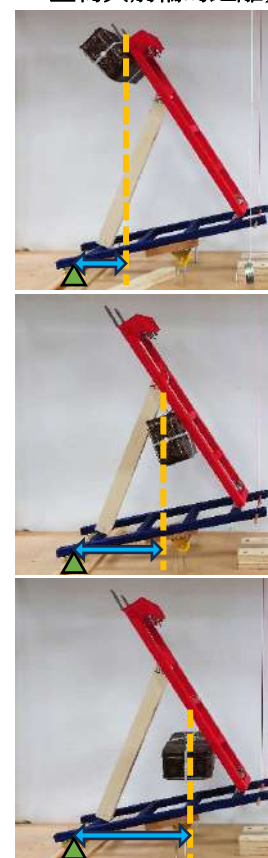
圖 4-10【固定支撐位置但改變重物與前輪的距離】
