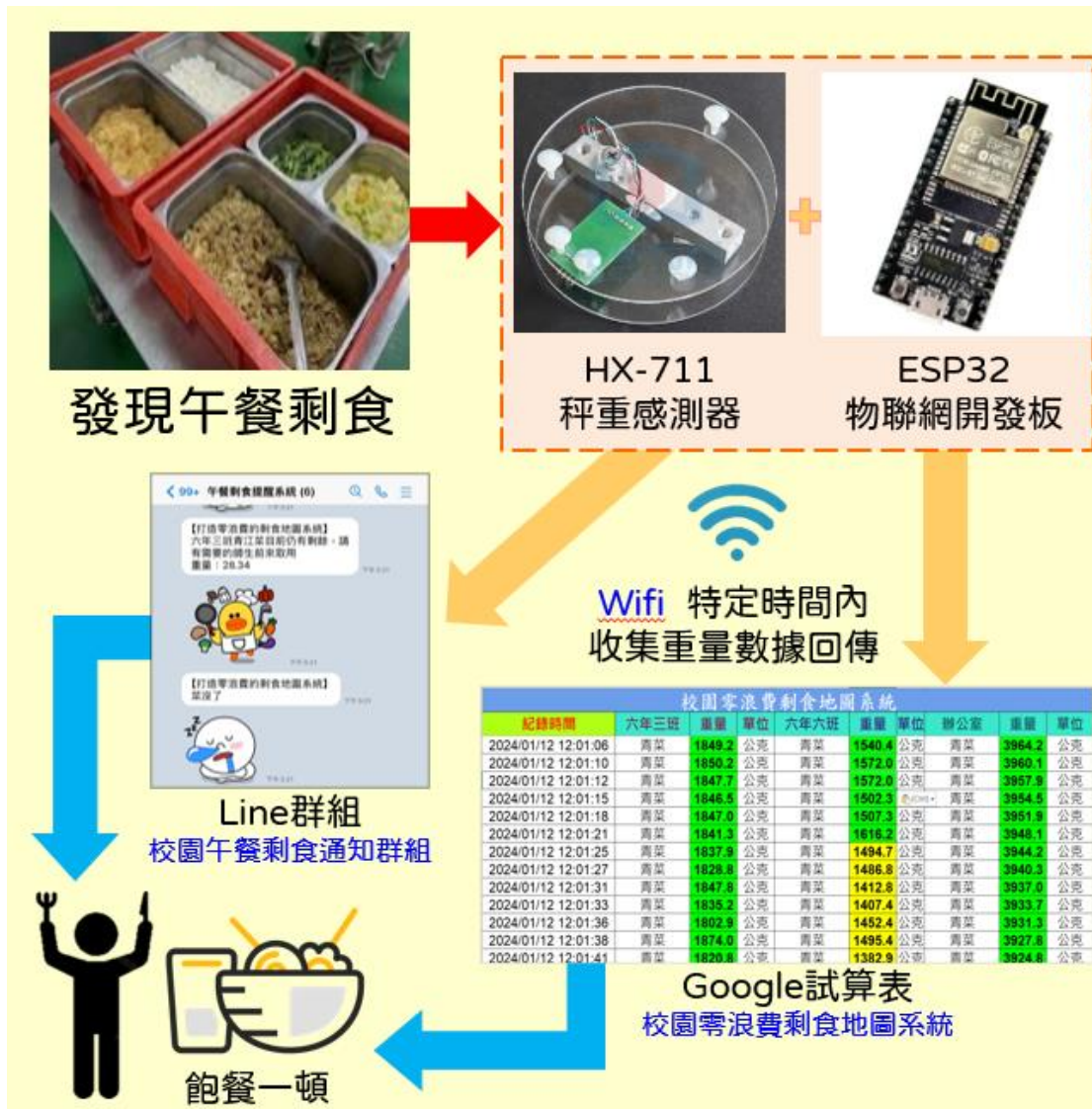
圖 2-2-1 秤重感測器裝置運作示意圖
