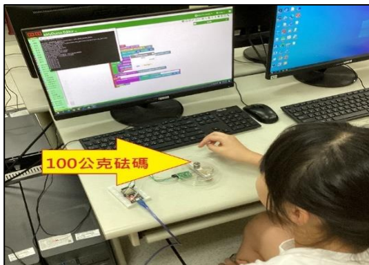
圖 4-1-1 秤重感測器 HX-711 初設始化設定
