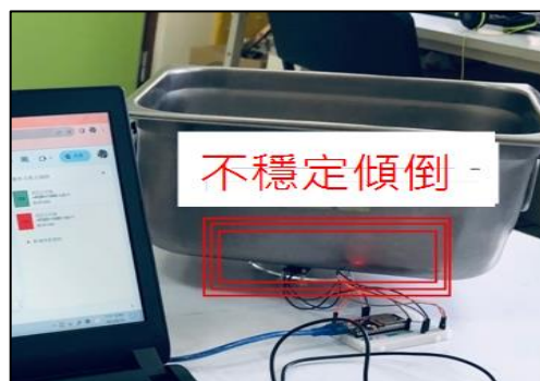
圖 5-1-9 實測午餐菜盆—發現容易傾倒
