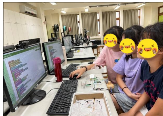
圖 4-1-2 連接秤重感測器積木編輯程式
