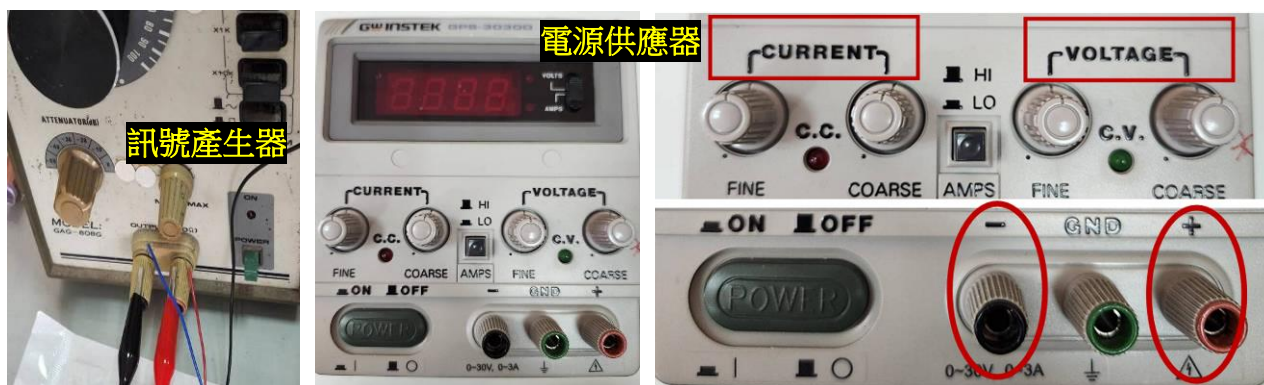
圖 1.11：將示波器紅、黑鱷魚夾接到訊號產生器訊號出口處(圖左)。電源供應器接出正負極，調整電壓(Voltage)、電流(Current)時，先粗調(Coarse)再微調(Fine) (圖中、右)。[1]
