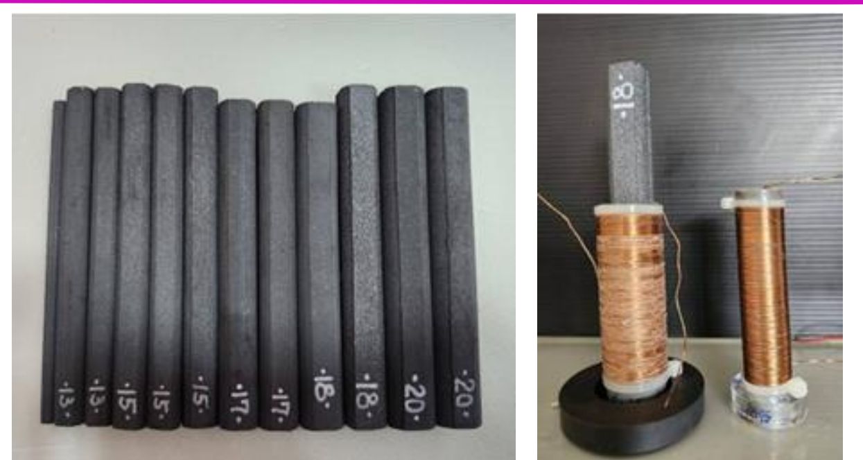
圖8.1：不同粗細的鐵氧芯。為了放粗的鐵氧芯特別纏一組85匝線圈[1]
