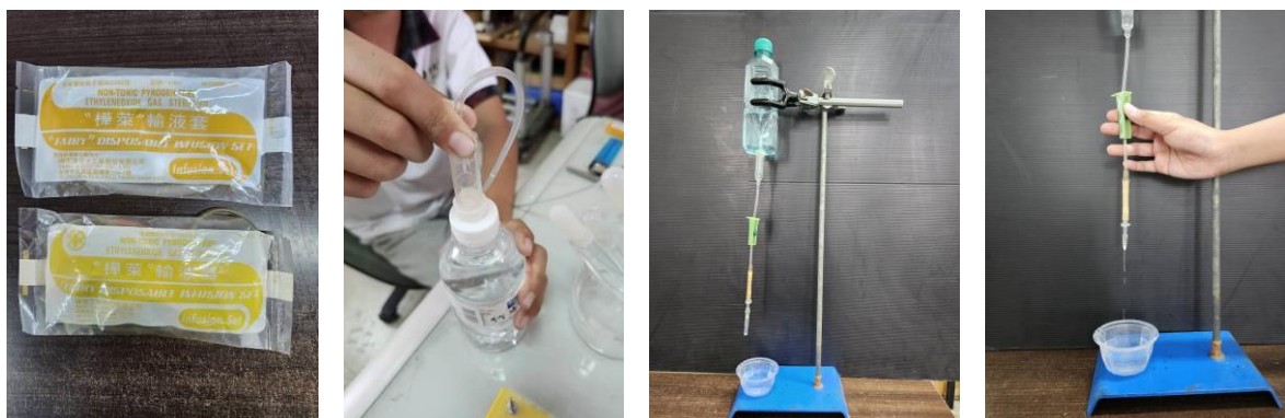
圖 L：使用點滴的輸液管，測試接在寶特瓶上。架在支架上調整控制水滴速度[1]
