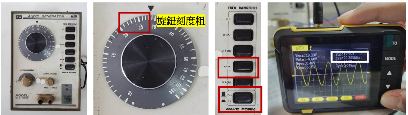
圖 1.10：訊號產生器刻度粗，不容易知道所調的頻率究竟是多少，很容易錯過。 頻率範圍選擇 x1K 表示在 KHz 範圍 。人耳的聽力範圍一般在 20~20KHz，比 20KHz 大的是超音波。 我們頻率選擇是落在稍微高頻的區域 。波形(wave form)選擇是像波浪的 正弦波 。示波器可以精準讀到訊號產生器的頻率，可以一面看著示波器頻率(Fre:20.365KHz 白框處)進行精細調整。[1]
