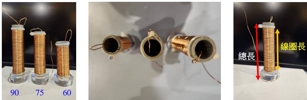
圖 3.1：90、75、65 匝線圈。使用相同粗細的 PVC 管纏線圈。線圈長、總長的說明。[1]
