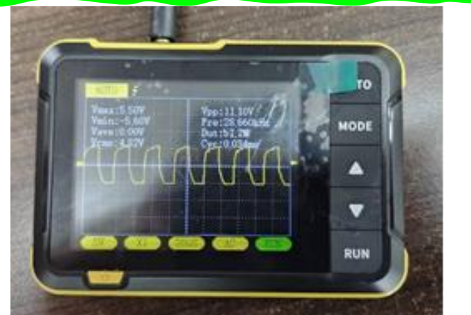
圖J:示波器讀到方波波型[1]
