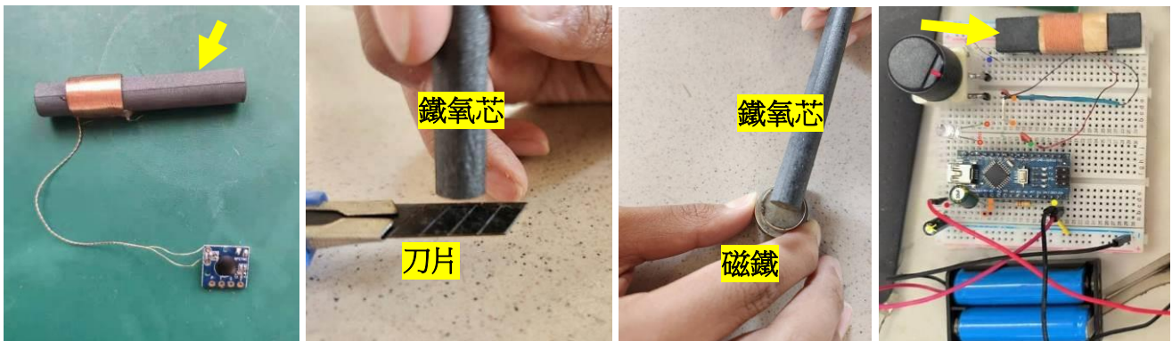
圖 1.2：電波時鐘裡的鐵氧芯(左)。鐵氧芯 無法 吸住刀片，可以被磁鐵磁化。鐵氧芯 用在人體收音機(右)。[20、1、1、2]
