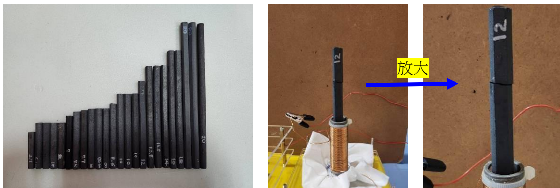
圖 6.1：準備不同長度鐵氧芯進行實驗。很明顯看出 12cm 鐵氧芯被震斷的情形。它一被震斷就沒辦法再將水滴氣化。[1]
