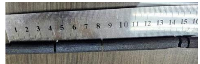
圖H:上邊兩圖是長度15.6cm鐵氧芯震斷成5節，它是唯一一個被震成這麼多節。幾乎所有斷面都非常平整如右圖。[1]
