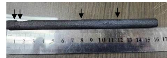
圖H:上邊兩圖是長度15.6cm鐵氧芯震斷成5節，它是唯一一個被震成這麼多節。幾乎所有斷面都非常平整如右圖。[1]
