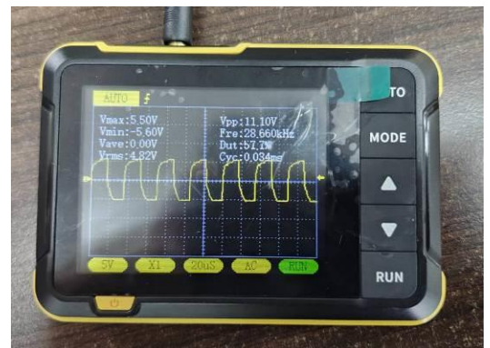
圖 J：示波器讀到方波波型[1]
