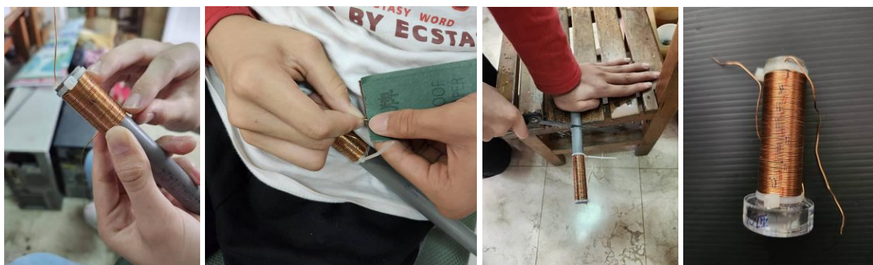
圖 1.3：纏線圈、去除絕緣漆、鋸 PVC 管、線圈上面可以明顯看到計數。[1]
