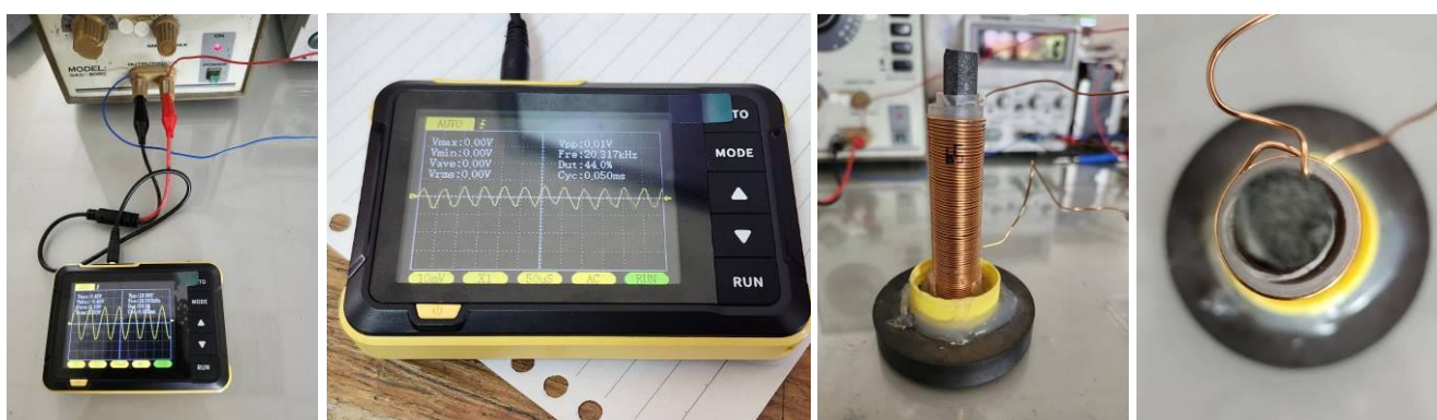
圖 2.3：示波器讀取訊號產生器的訊號頻率(左圖)。線圈底部必須有磁鐵，線圈內有鐵氧芯。 注意鐵氧芯不可以有任何一端一邊用膠粘住，必須是活動的 ，可以用棉花或橡皮筋稍微固定棒身別讓它傾斜[1]。
