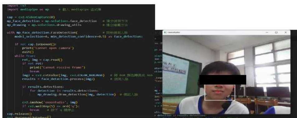
圖 3-4 測試 Mediapipe 即時偵測人臉
