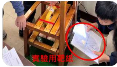
(2) 設定標準化程序：先拍攝爆米花原形，再用雙面膠黏在「標準化實驗靶紙」的中心點上，最後放置在脆裂儀下方。
