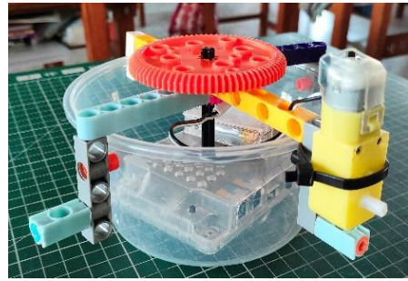
圖十三-2 第二種積木結構外掛 TT 減速馬達「90度」
