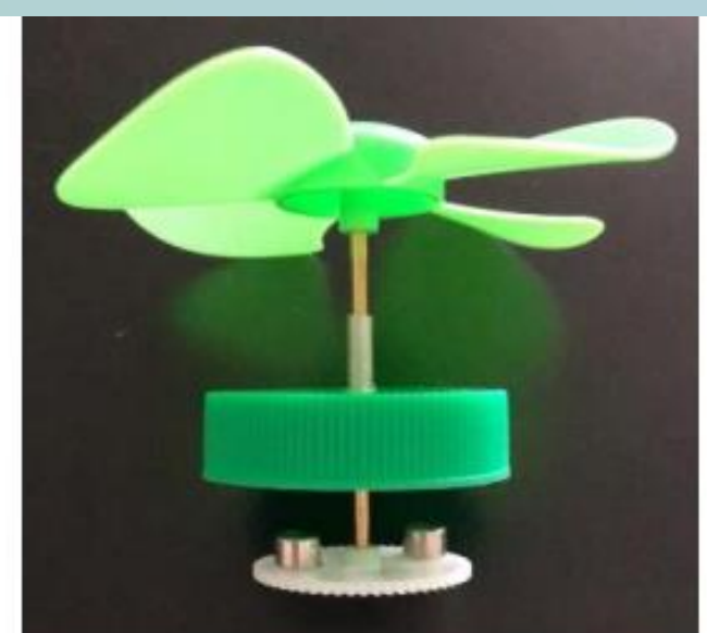
圖二 磁力傳動裝置 (收納盒外的結構與零件)
