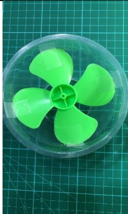
圖二十三-11 風扇螺旋槳裝入 已裁底塑膠杯(正照)
