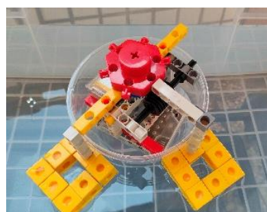
圖十二-2 第一種積木結構外掛 TT 減速馬達「90度」
