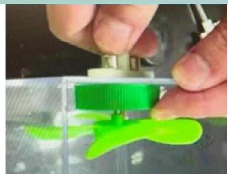
圖一 磁力傳動裝置 (說明懸臂的磁鐵以吸力帶動瓶蓋中齒輪的磁鐵)
