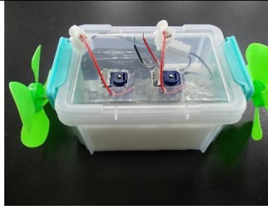
圖二十三-5 磁力傳動裝置 (風扇螺旋槳)
