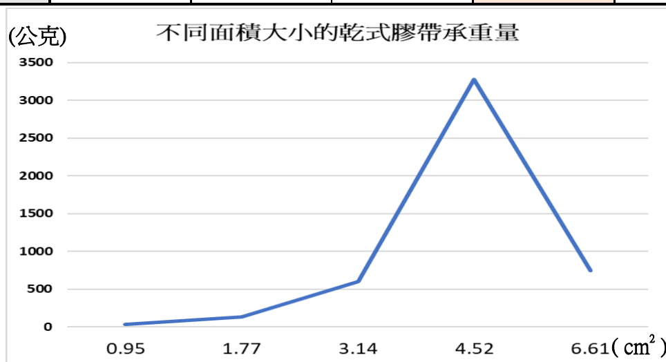
圖 9 不同面積大小乾式膠帶的承重量 ※本統計圖由第 4 作者繪製
