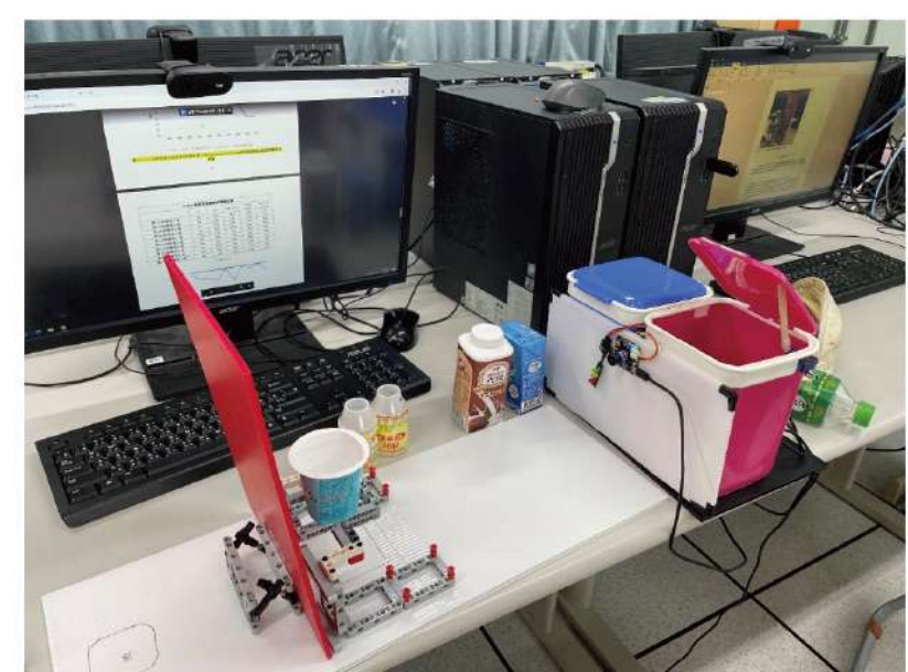
圖三十三: RFID雲端自動積點AI辨識回收垃圾自動開蓋垃圾桶, 自行拍攝
