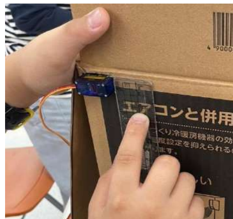
圖十六: 伺服馬達孔位開孔裝設，自行拍攝
