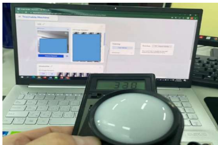
圖十三:Teachable Machine Image 訓練時的環境亮度(lux)偵測，自行拍攝
