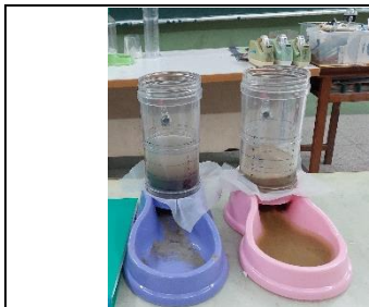
圖 1-7 放置 24 小時後，田土(右側)水都已滲漏
