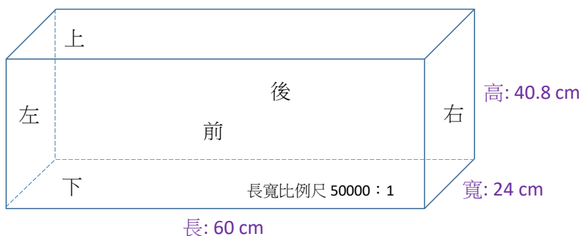
圖 7：水氣通過山區實驗模型壓克力箱。
