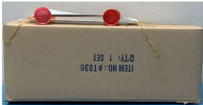
圖十七 紙箱式地震模擬平台
