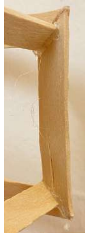
圖三十九 冰棒棍(寬度為 1 公分、厚度為 0.2 公分)，在所有模擬房屋的材料中是最寬的
