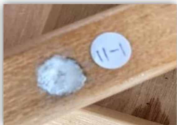
圖十四、測試日本藍泥蜂白門透氣性與比較防水性。(照片：作者拍攝)
