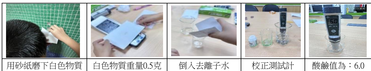
圖十一、測試日本藍泥蜂白色封口酸鹼值。(照片：作者拍攝)
