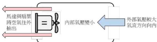
圖 1-3-2 真空吸力應用 (圖片來源：本圖由作者 2 繪製)
