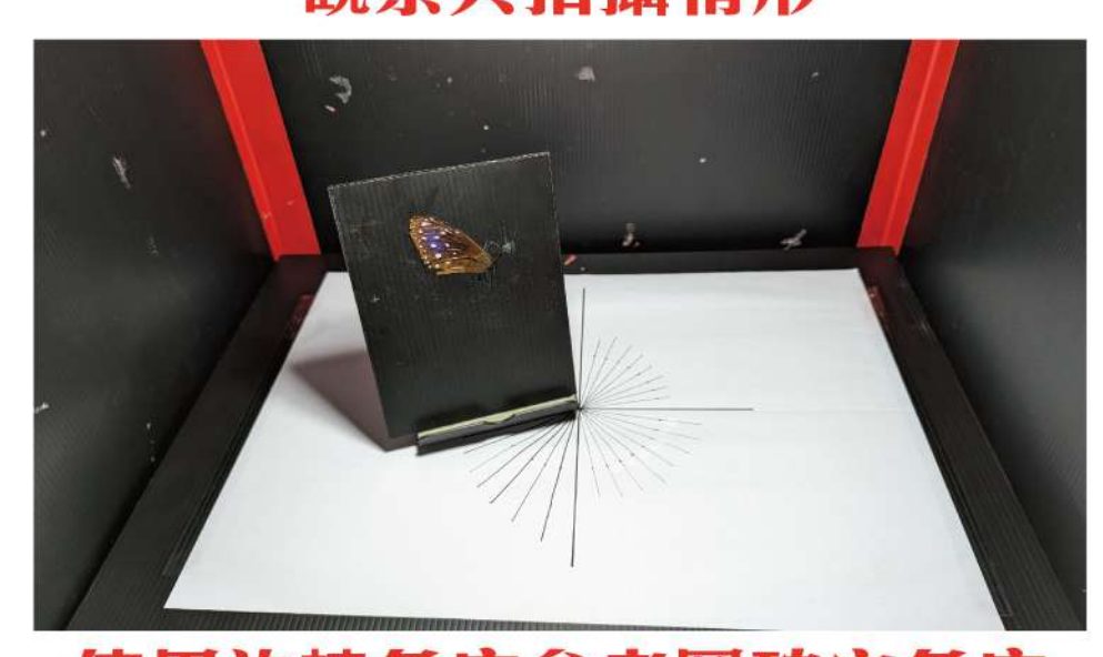
使用旋轉角度參考圖確定角度 (使用之圖片為本次實驗時拍攝)
