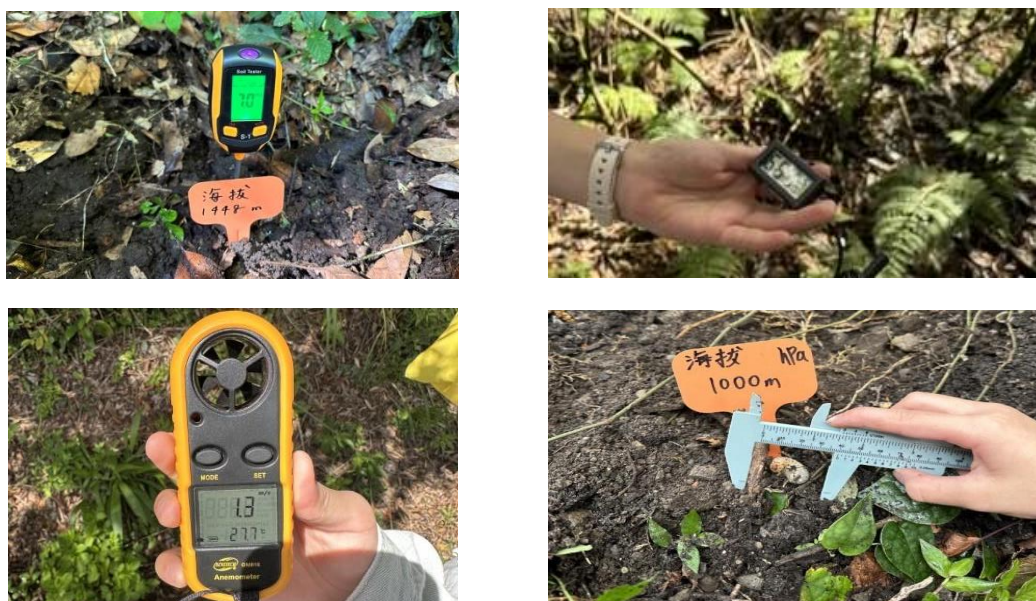
圖 12 新竹字老海拔及土壤溼度偵測（左上）溫度及溼度測量（右上）風速測量（左下）（本照片由作者自行拍攝）
