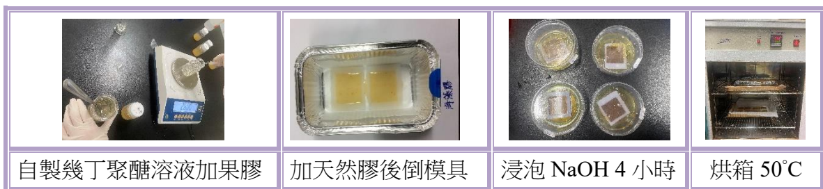
【圖 18】自製幾丁聚醣膜加入添加物及浸泡於氫氧化鈉溶液
