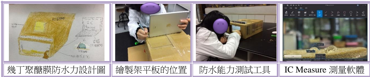
【圖 10】幾丁聚醣膜防水能力測量過程
