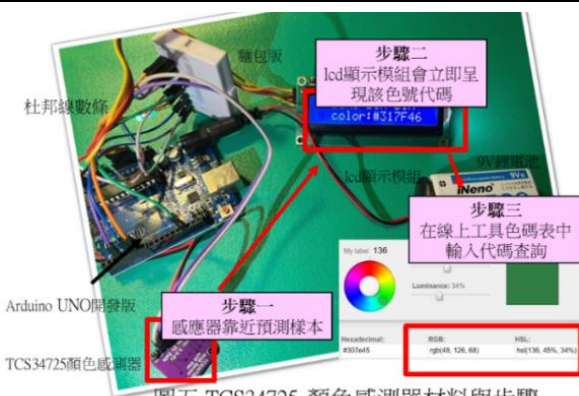
圖五 TCS34725 顏色感測器材料與步驟
