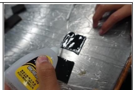
在滴上三秒膠後，觀察皮革黏固情況
