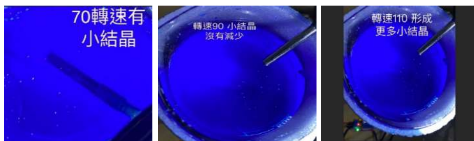
圖八 不同轉速的結晶效果 (第一作者拍攝)
