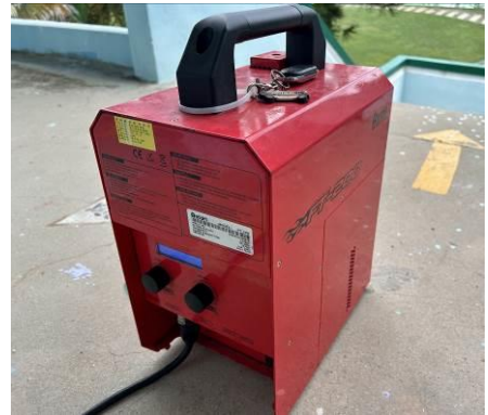
照片 19.發煙器(需通電預熱) 照片出處：自攝(2024)
