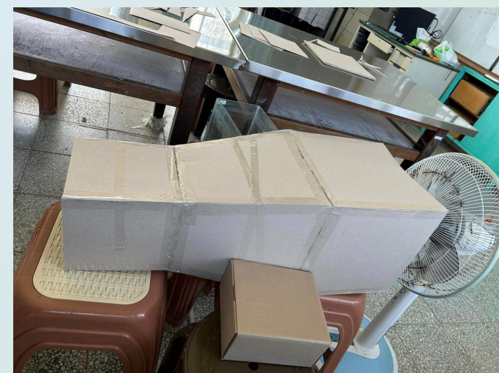
照片7.硬紙板風洞能將風力均勻化
