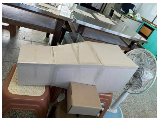
照片 7.硬紙板風洞能將風力均勻化
