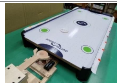
圖 49：釋放裝置撞擊圓柱體，使其射出
