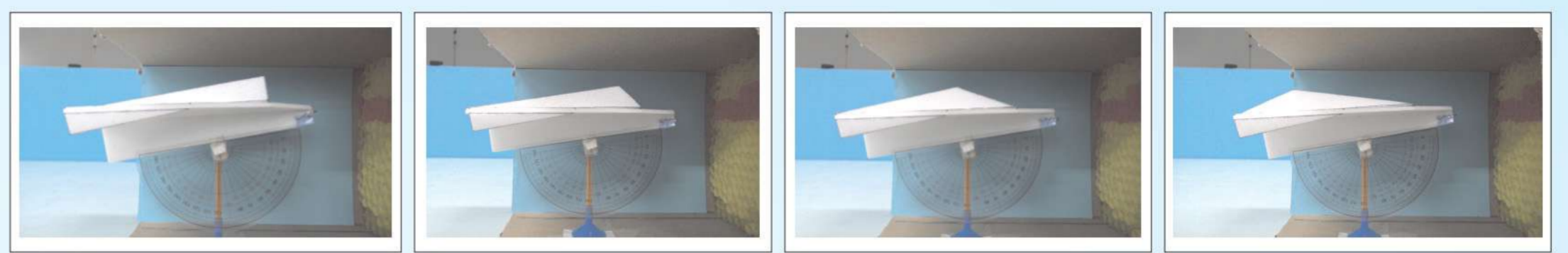
圖5-3.(a) 84° 翼刀持續時間最短 圖5-3.(b) 42° 翼刀持續時間約11.7秒 圖5-3.(c) 21° 翼刀持續時間約3.7秒 圖5-3.(d) 10.5° 翼刀持續時間最長
