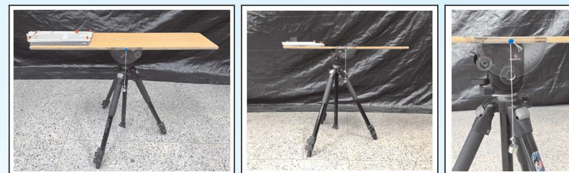
圖三-3.(a)利用智高積木組成發射軌道，在前端固定彈弓橡皮筋。 圖三-3.(b)將發射軌道鎖在木板上，木板則固定腳架上。 圖三-3.(c)在木板外側貼上量角器，量角器固定一個鉛垂線，以便調整發射角度。
