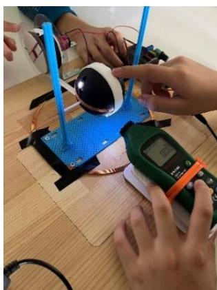
圖十一 接收線圈感應到電流使 LED 發光
