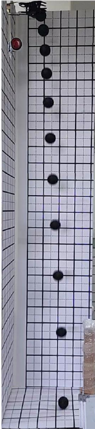
圖十六 圓球側面落下運動過程圖 (本圖為研究者自行拍攝)
