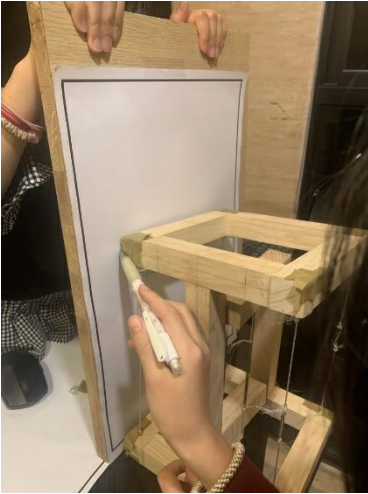
圖九、以角度測量紙與直立測量板紀錄傾斜角。(由指導老師拍攝)
