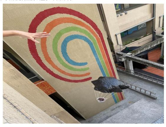
八、透過固定在降落傘下傘杯中的 micro:bit, 記錄降落傘開始降落到落地過程中加速度與時間關係資料,並由連接電腦讀取。
