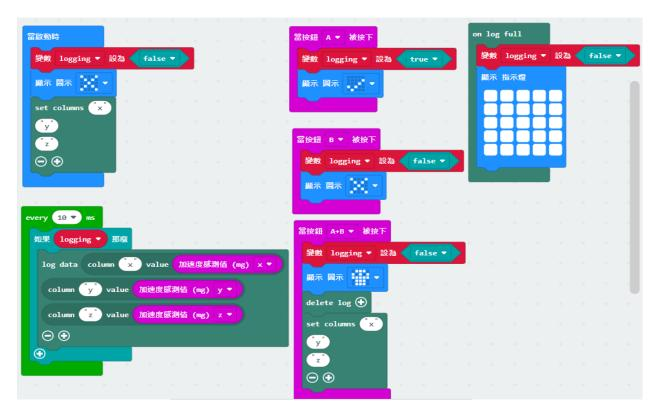
十、將讀取的資料轉至 excel,並製作加速度與時間關係圖,由圖中加速度開始減少至 0 時, Z 軸曲線與時間軸圍成的面積,在 excel 中輸入梯形面積公式來計算,可以計算速度變化量,由於初速度為 0,區間累計變化量即為終端速度。
