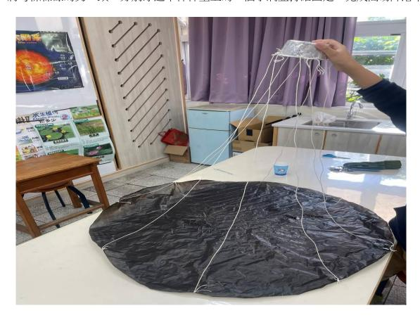
六、將測試降落加速度用的 micro:bit,板面黏貼固定於降落傘下的傘杯後,就可以進行降落 測試。
