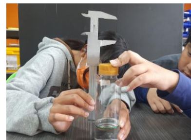
圖 4-17、以游標尺測量瓶底到質心線的距離
