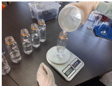
圖 4-7、以電子秤測量倒入瓶中環氧樹脂的重量
