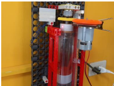
圖 4-12、以自製調速器改變水瓶的轉速
