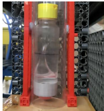
圖 4-20、黏度低(30 度)甘油瓶的碰撞情形
