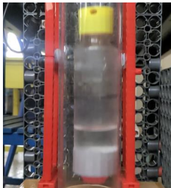
圖 4-19、黏度高(10 度)甘油瓶的碰撞情形
