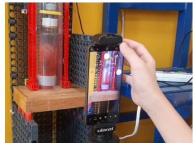
圖 4-14、以手機超慢動作攝影功能拍攝液體流動的情形
