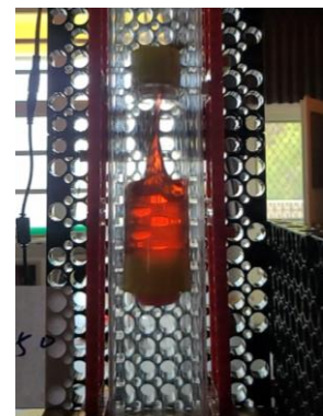
圖 4-11、瓶內流體碰撞後的動態影像
