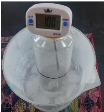
圖 4-18、以食鹽和冰塊降低甘油的溫度
