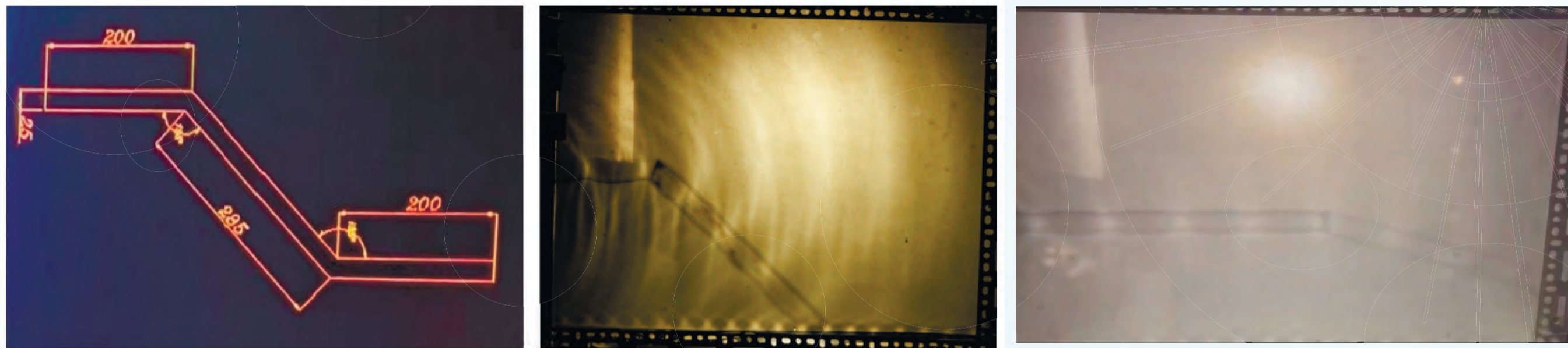
失敗的彎折小振幅淺水波波導設計，水波輸入端僅200mm 即作45度角彎折
