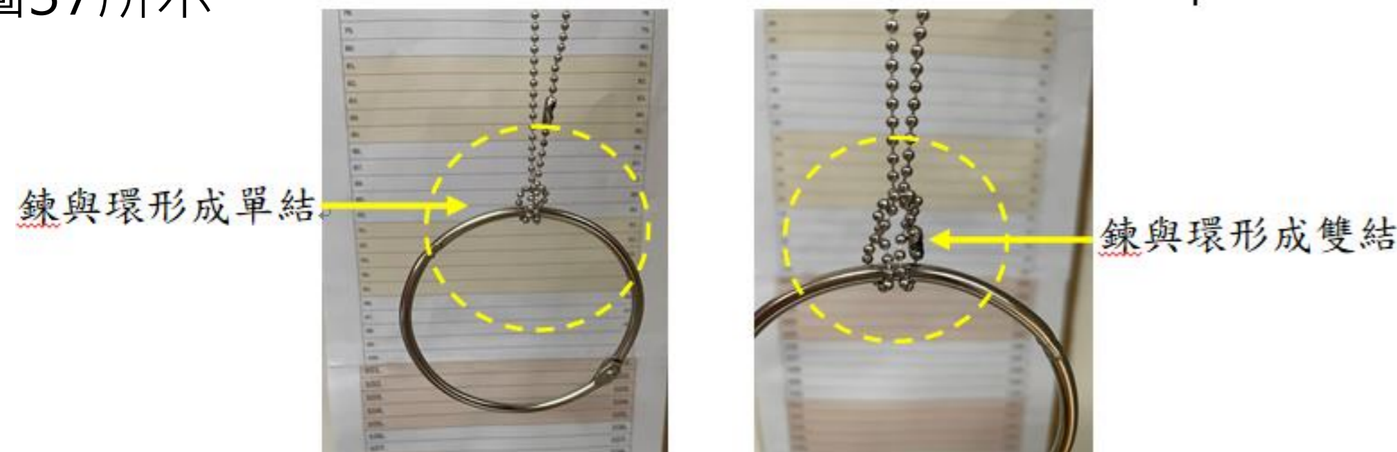
圖36. G環套較短的甲鏈成單結 圖37. G環套很長的甲鏈成雙結
