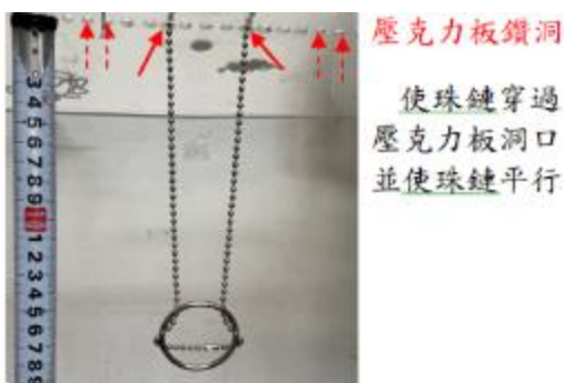
圖 15. 鑽孔穿入珠鏈並固定
